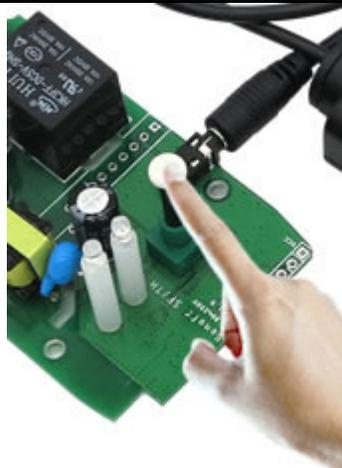
4. Desenrosque el tornillo en el dispositivo SONOFF POW y coloque el cable eléctrico, línea (L), neutro(N) y tierra (E) donde correspondan en la entrada, presione el pequeño clip blanco para colocar el cable y suéltelo para sujetarlo. Lo mismo para la salida. Asegúrese de que el dispositivo y el teléfono inteligente están en el mismo entorno Wifi. Diagrama de Conexión:
